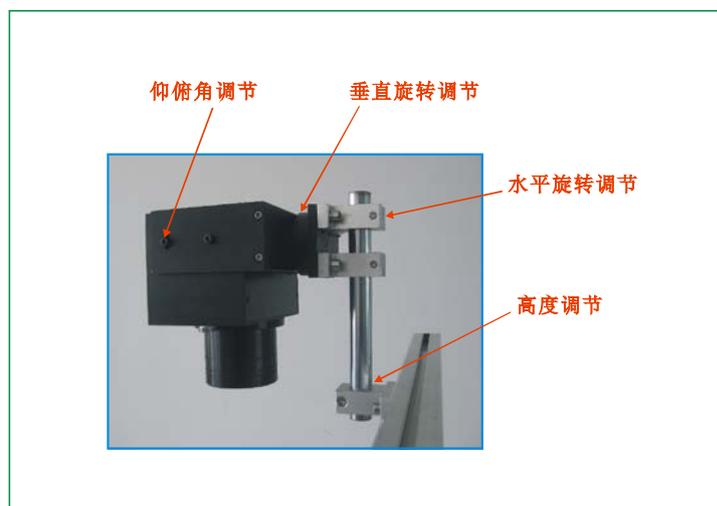
图示 1 CCD 传感器调节机构示意图
